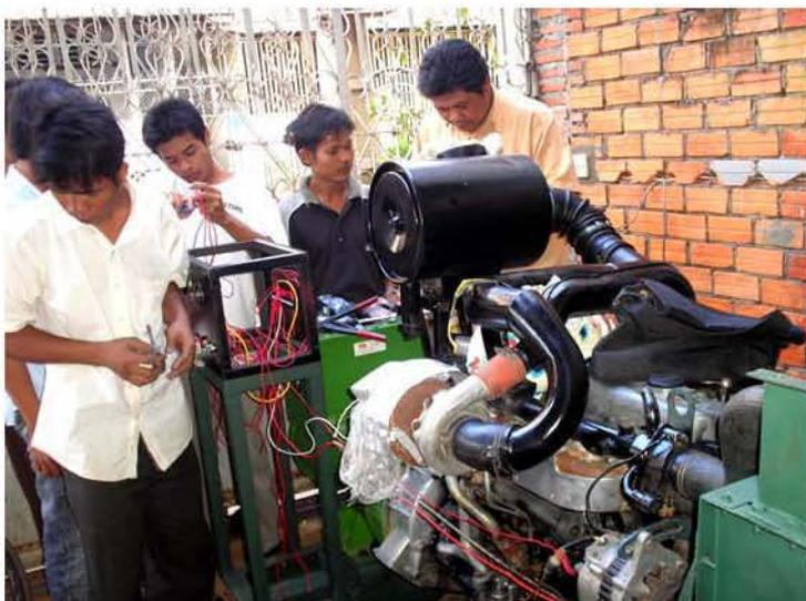
Travail concret : montage d'un groupe électrogène
