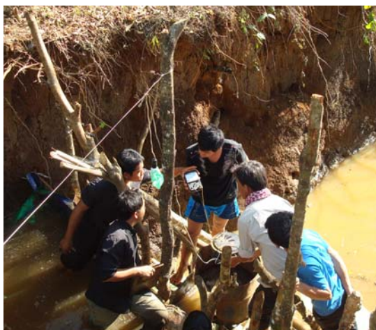
On n'a que 150V. Il faut allonger la hauteur de « fuite »
